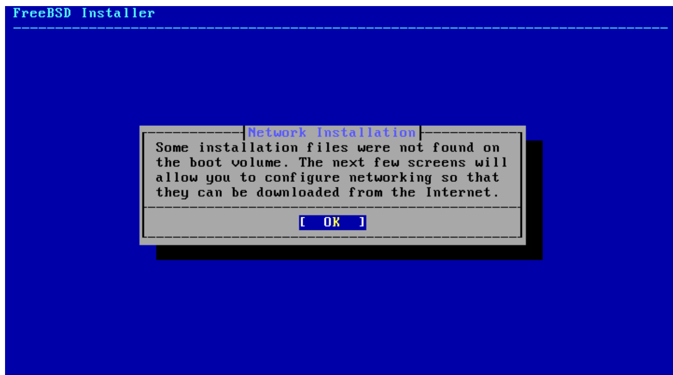
Figura 9. Instalando a partir da rede
